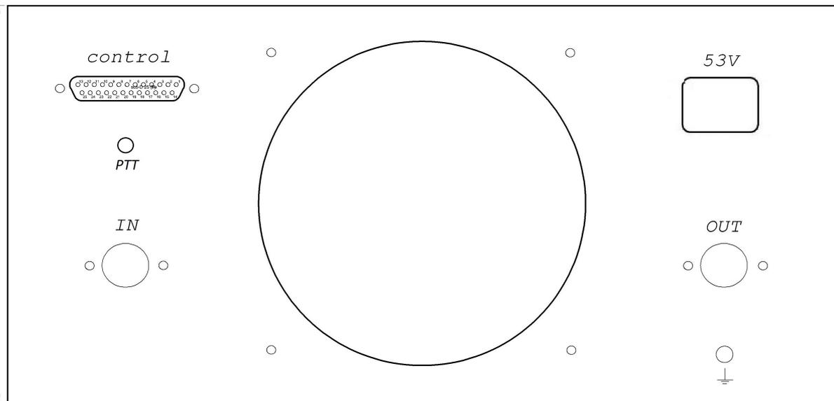
OUT – ВЧ разъем для подключения антенны.
