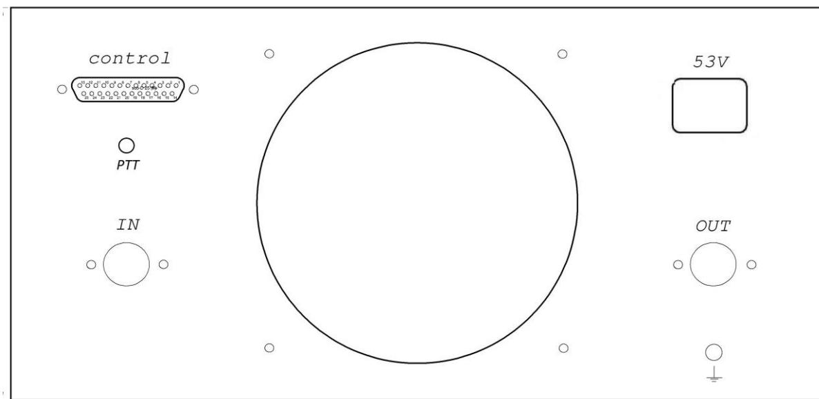
**OUT** – ВЧ разъем для подключения антенны.
