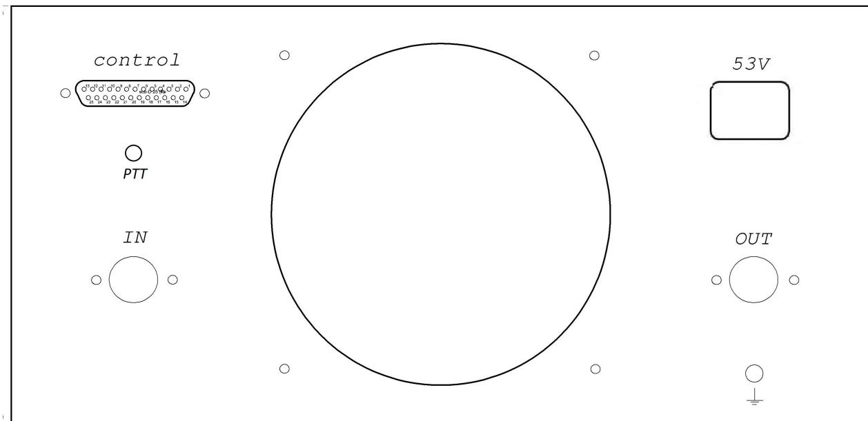
**OUT** – ВЧ разъем для подключения антенны.
