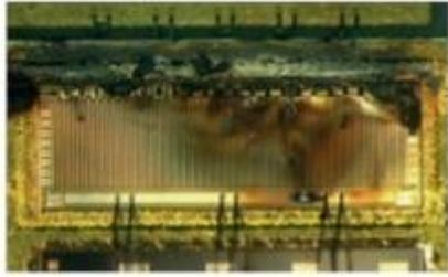
Рисунок 3: Пример отказа теплового устройства в результате высокого
