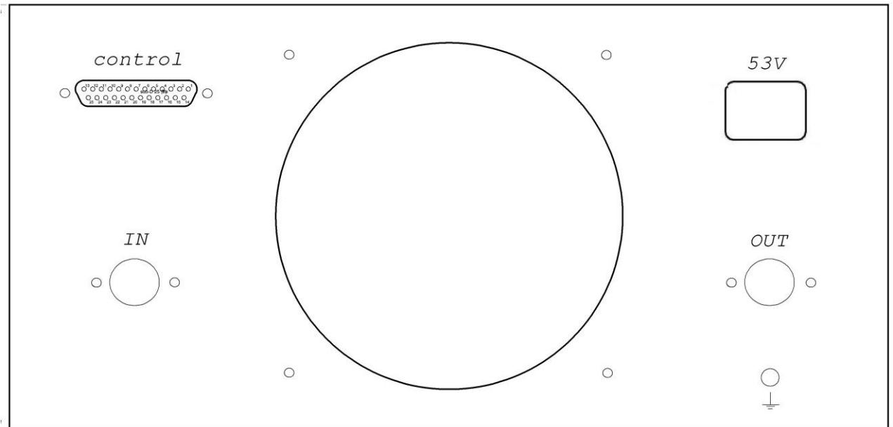
**OUT** – ВЧ разъем для подключения антенны.
