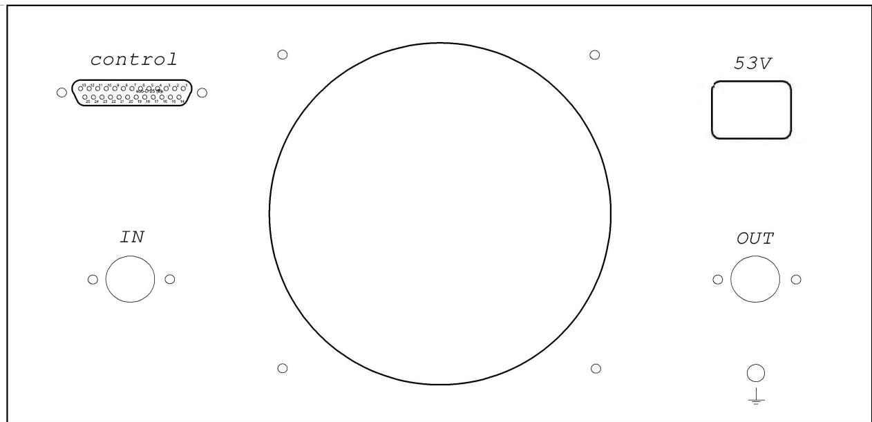
OUT – ВЧ разъем для подключения антенны.
