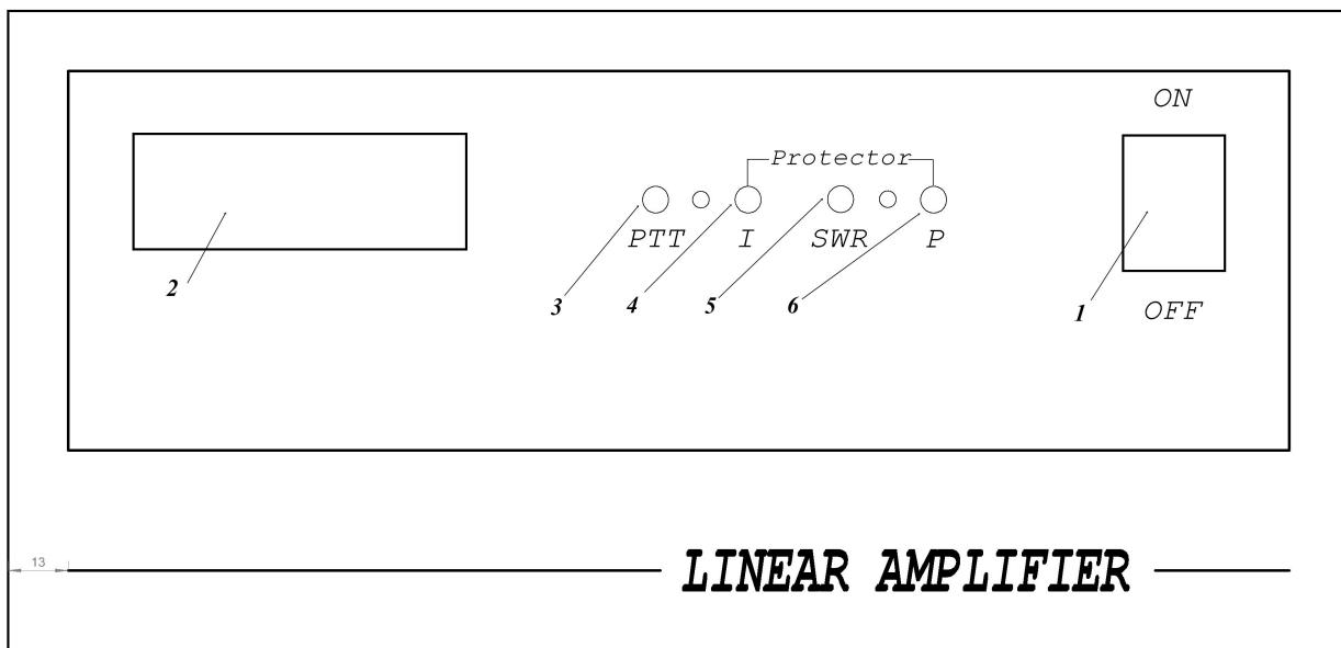
1. Клавишный переключатель включения и отключения питания усилителя мощности.
